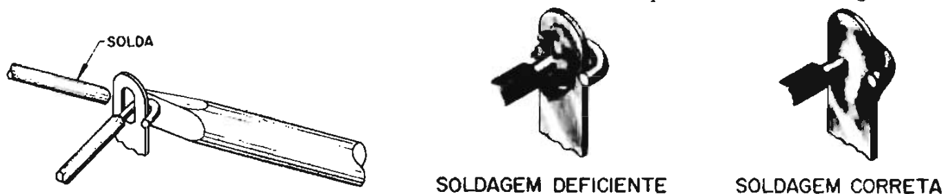
Figura 4 - Detalhes da ligação e soldagem a terminais
